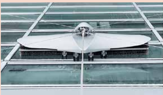
▲ Met behulp van 4 kabels verbonden aan de 4 hoeken van de gevel beweegt de robot zowel verticaal als horizontaal en reinigt het in één keer de gevel.
