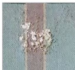
4 doorslag opgezwollen lijm en verflaag doek Z-ZW links 47
